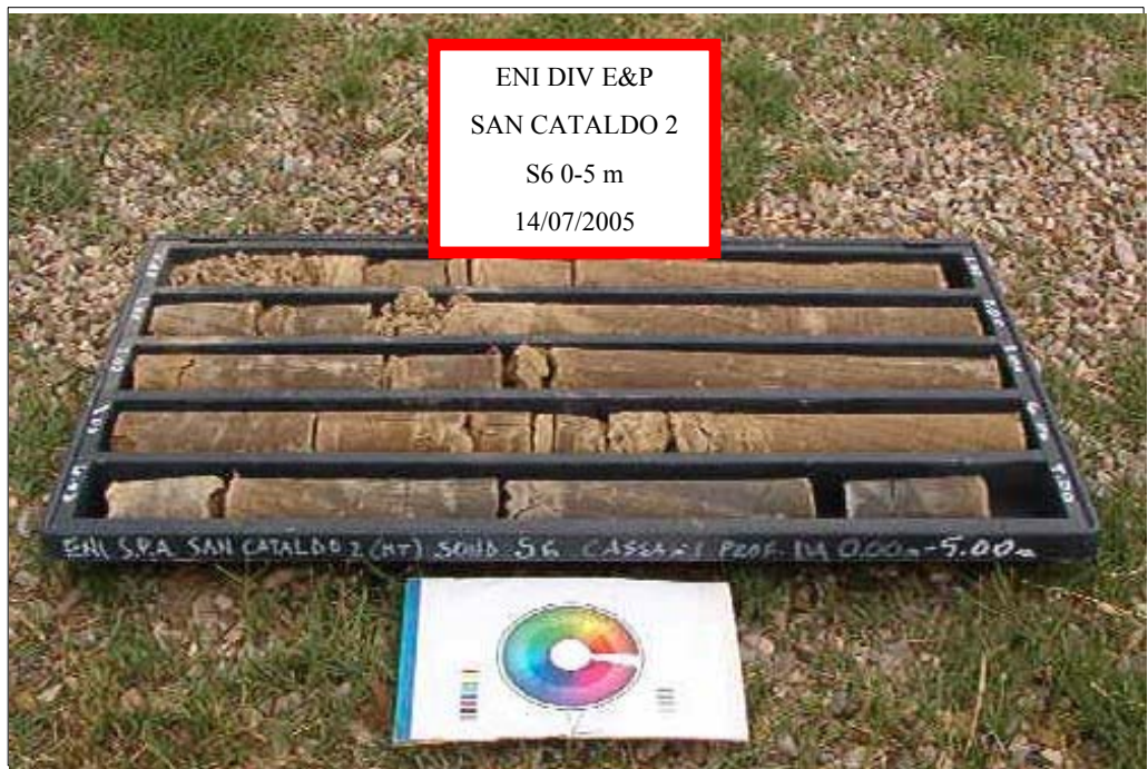
S6 : PERFORAZIONE 0 - 5 m
