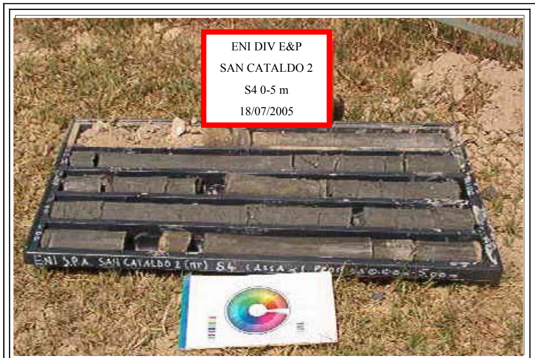
S4 : PERFORAZIONE 0 – 5 m
