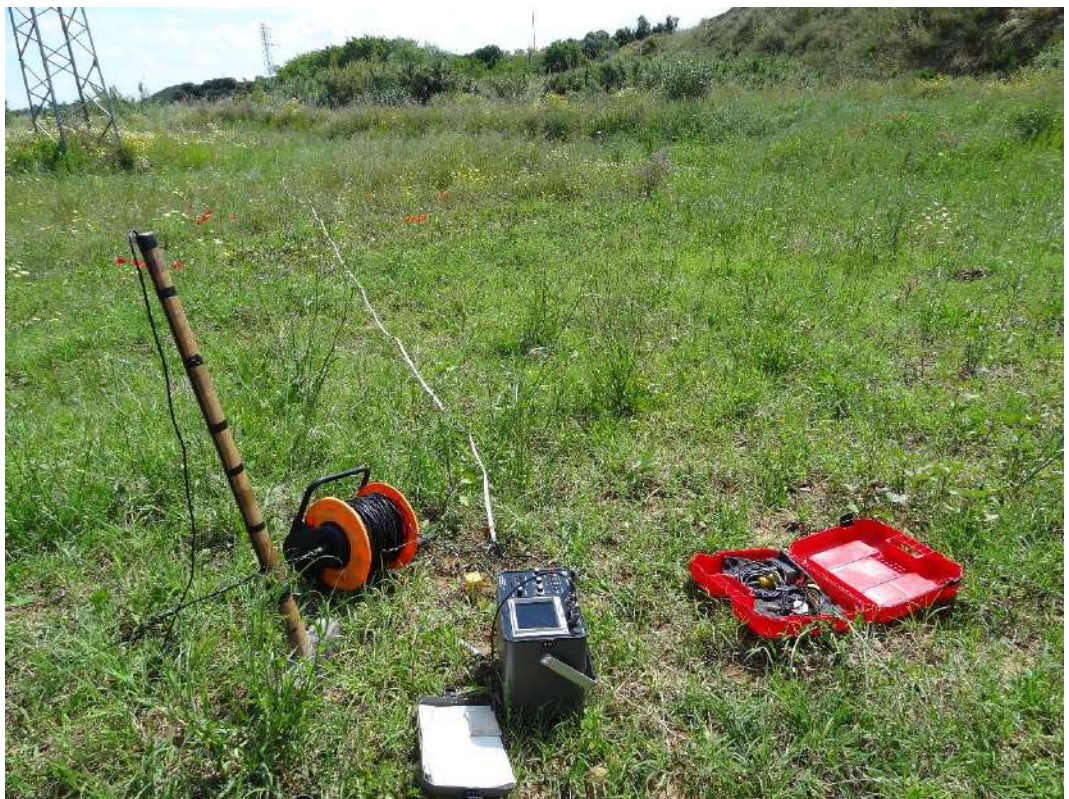
Figura 6. Sismografo e relativa apparecchiatura utilizzati per la prospezione in onda sismica P-SH.
